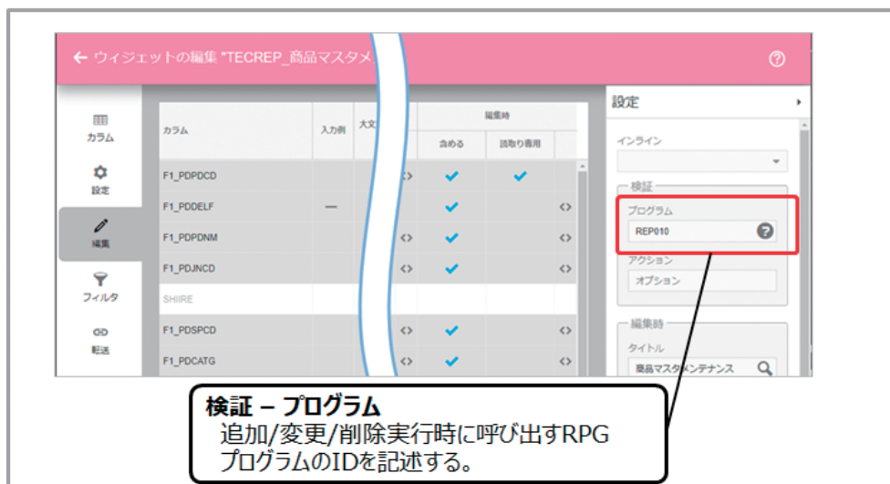
図 7 Edit Grid – RPGプログラム設定方法
