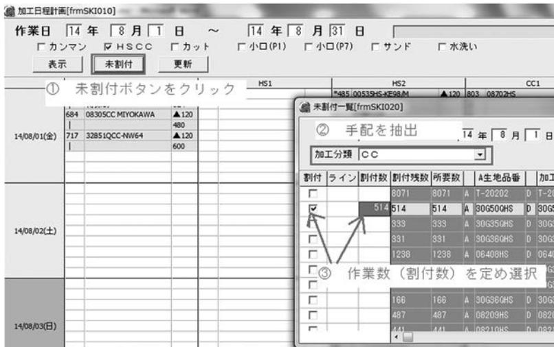
図5 手配からスケジュールへの割り付け(割り付け後)
