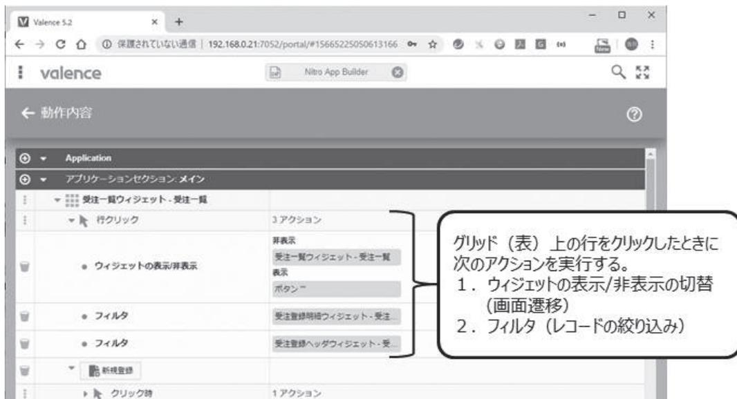
図7 クリック時のRPG呼び出し
