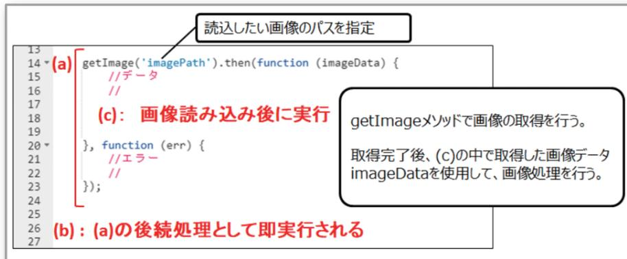
【図14】の処理だが、(a)の部分が画像を読み込むメソッドとなっている。画像の読み込みが完了すると、取得した画像情報が `imageData` にセットされるので、取得後の画像処理を(c)の部分に記述すればよい。但し、このメソッドには注意点がある。画像の読み込み処理自体は非同期で行われる為、(a)の後続処理部分である(b)の部分は、(a)の実行後に即実行されて
