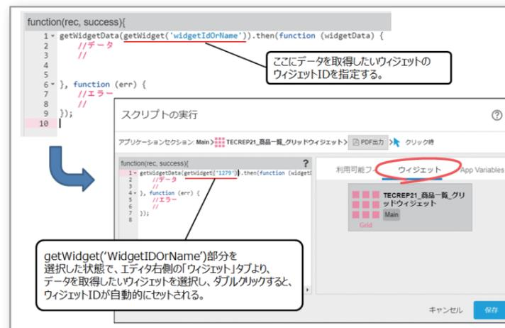
これで目的のウィジェット上のデータがスクリプトの中で取得できるようになり、取得したGridウィジェットの一覧データがwidgetData変数にレコード件数分の配列として格納される。
