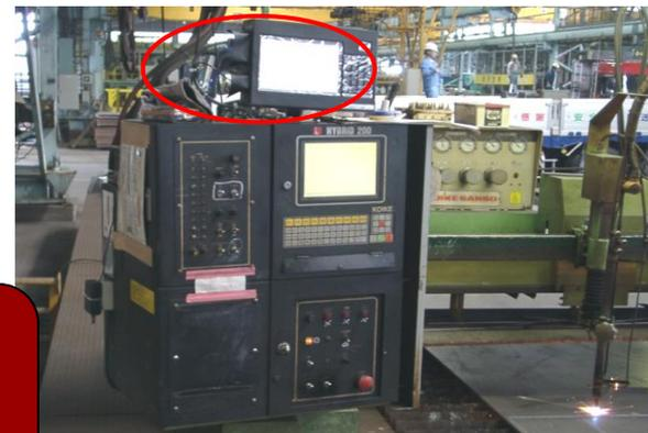
ガス切断機に搭載した端末
